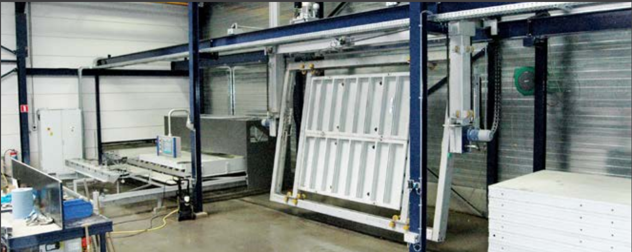
Zelfontwikkelde wasmachine: poetsen & polieren voor panelen van BECONA én andere merken
